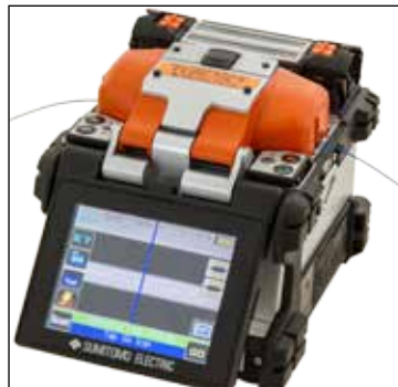
Kuva 4.18. Esimerkkejä jatkoskoneista (Fujikura, Sumitomo).
