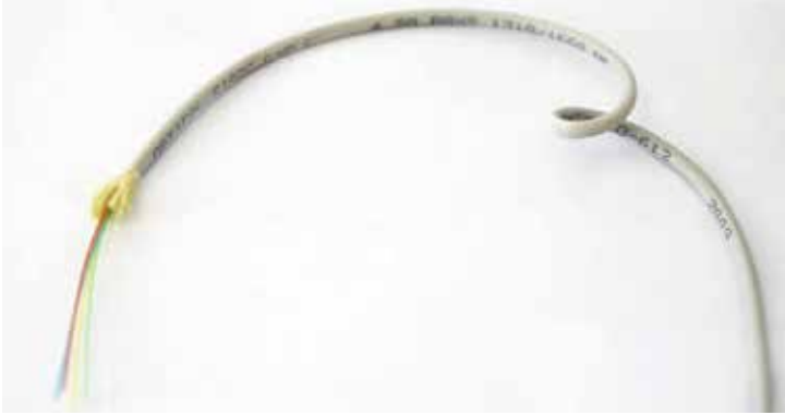
Kuva 4.7. Kaapelin asentamisen yhteydessä syntynyt kohtalokas silmukka eli ”sinkku”.
