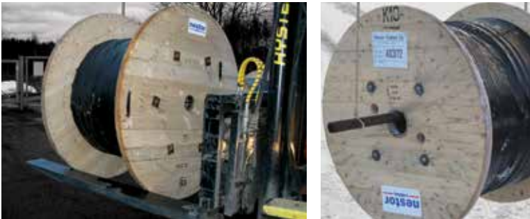
Kuva 4.1. Kaapelikelan käsittelyä trukilla ja nosturilla.
