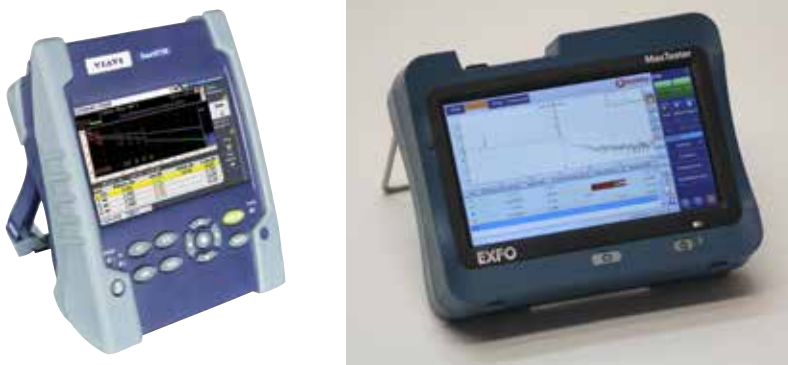
Kuva 5.12. Esimerkkejä kiinteistöjen optisten kaapelointien mittauksiin soveltuvista valokaapelitutkista (Viavi, EXFO).
