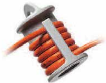
Kuva 5.2. Esimerkki monimuotokuitujen vaimennusmittauksessa käytettävästä tuurnasta.
