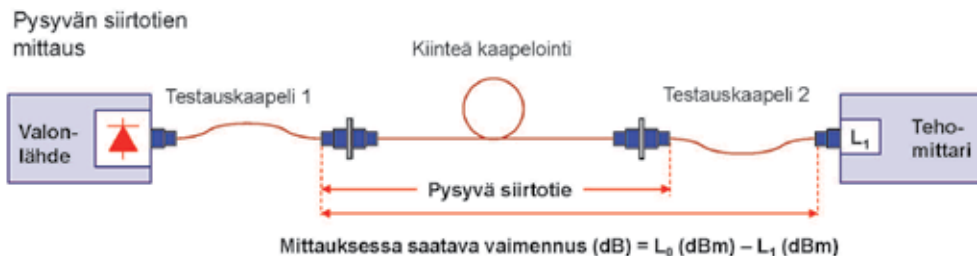
Kuva 5.6. Vaimennuksen mittaus. Kuvasta käy myös ilmi, miltä osuudelta vaimennuksen mittaustulos saadaan, jos vertailuteho L_1 on mitattu yhden testauskaapelin menetelmällä.
