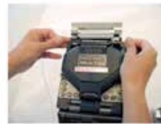
8. Jatkoksen suojaus kuitujatkossuojalla
